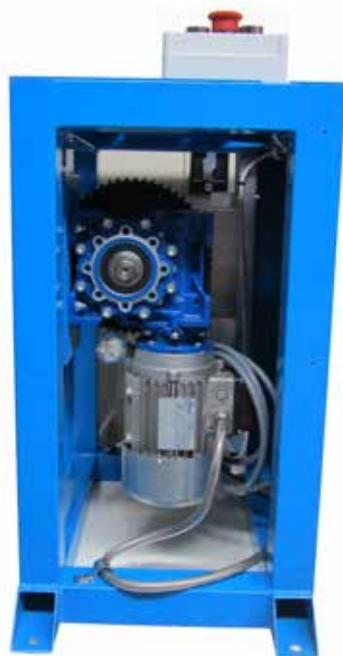
In aggiunta al motoriduttore è stato installato un inverter (non fornito da Motovario) con alimentazione monofase per il controllo del moto dell'elevatore e come protezione dell'operatore da eventuali sovraccarichi elettrici.
