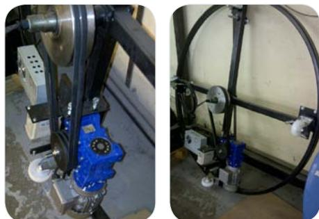
Si, en cambio, la velocidad del movimiento no es constante y presenta picos elevados de par, como en el caso de las torres de caída libre, se utilizan reductores de engranajes, serie H, tamaño 050, de 2 fases de reducción.
