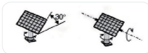
Movimientos de los seguidores solares biaxiales
